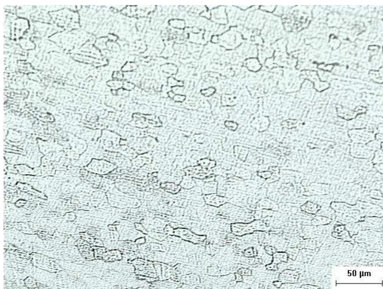
Figura 43: Estrutura ferrítica, aumentado em 200x com ataque Nital 2%. Detalhe do aço IF utilizado no estudo de Dias (2011).
