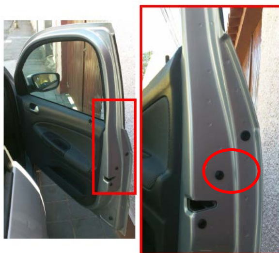
Figura 2: Impressões de pontos de solda em chapas de aço IF unidas por RSW.(DIAS, 2011)
