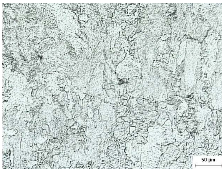
Figura 39: Microestrutura da lente de solda do aço IF com aumento de 200x e ataque de Nital 2%. (DIAS, 2011)
